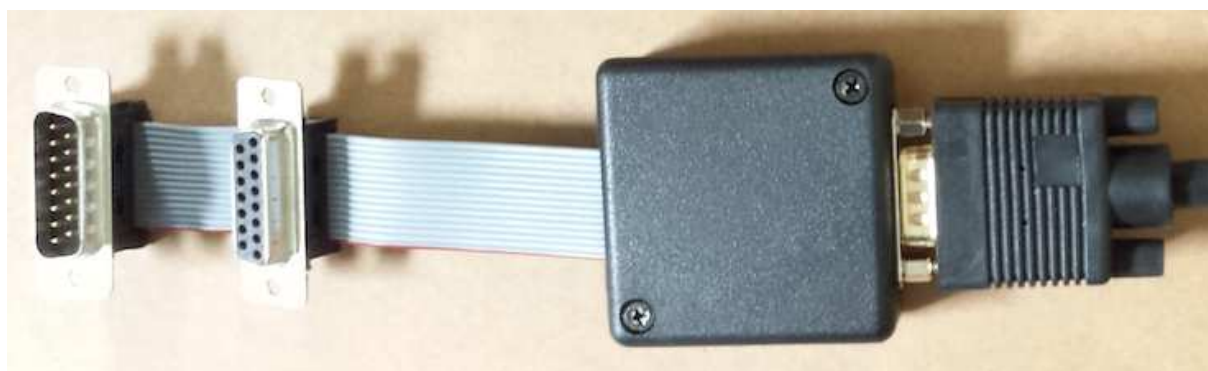
Boîte de conversion: Sub-D 15 HD Mâle / Sub-D 15 Mâle / Sub-D 15 Femelle.
