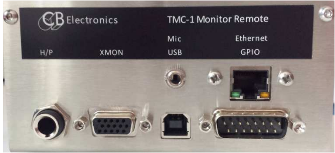
TMC-1 et TMC-1-S6, TMC-1 vue arrière avec les entrées Ethernet et l'entrée Mic d'Ordres.
