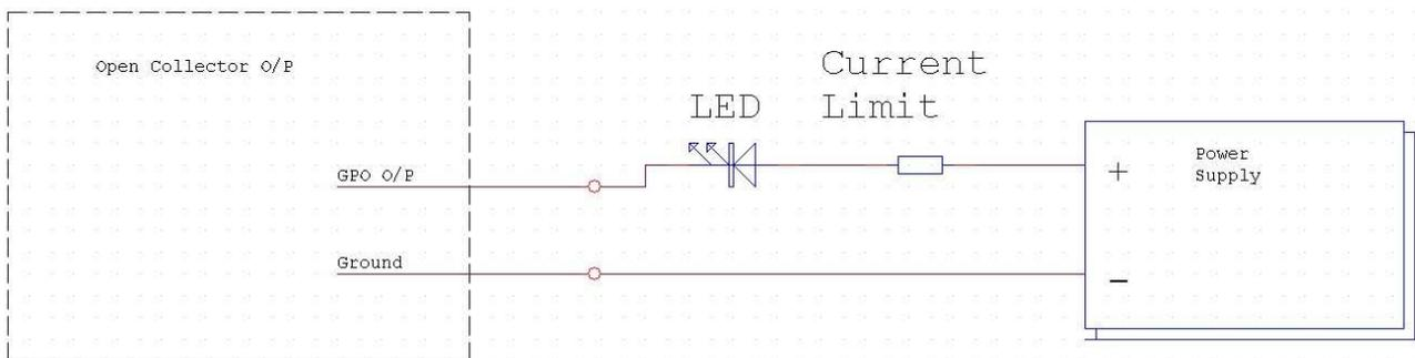
La résistance de limitation du courant peut être calculée. Pratiquement 330  $\Omega$  pour une alimentation de 5 V et de 1 K  $\Omega$  pour une alimentation de 12 V.
