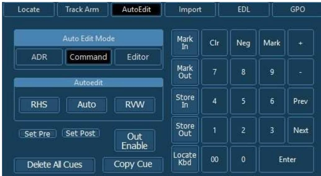
La touche [**AutoEdit**] permet d'accéder à la fenêtre du mode Montage Automatique. 'Auto Edit Mode' permet de sélectionner le type de mode de montage utilisé :
