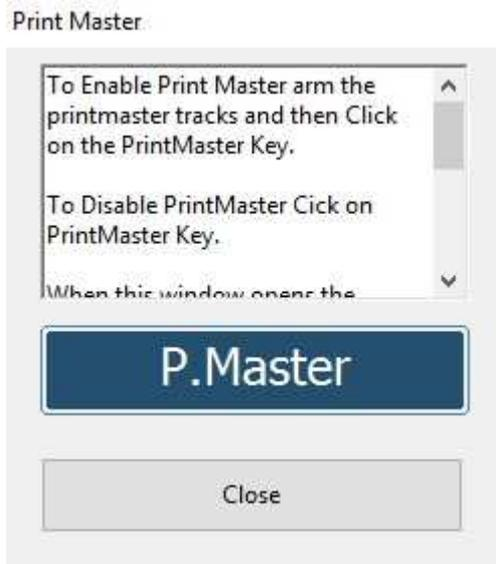
Pour Activer la fonction 'Print Master', dans la fenêtre 'Track Arm', sélectionner la piste ou les pistes voulues comme 'Print Master' et appuyer alors sur la touche [**Print Master**] située à droite de la fenêtre 'Track Arm' et puis sur la touche [**P.Master**] bleu. Lorsque 'Print Master' est actif, la touche [**P.Master**] devient rouge.
