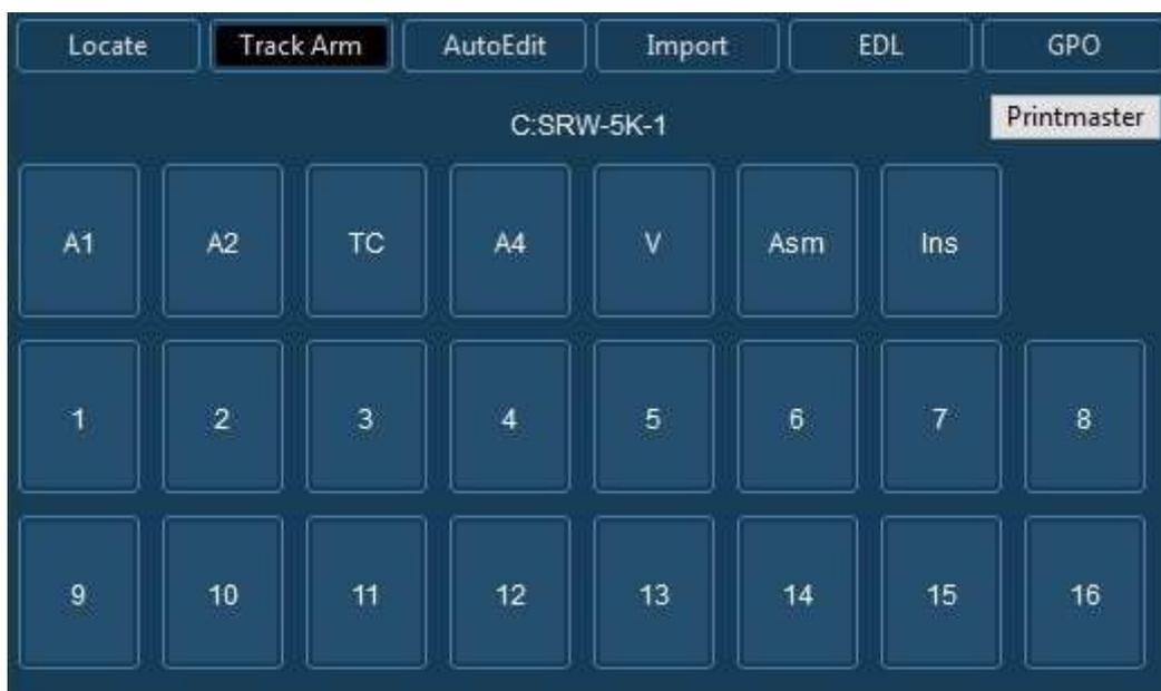
Lors de l'utilisation d'une machine type vidéo, la touche [**Track Arm**] permet d'afficher la fenêtre de sélection de piste pour l'enregistrement de cette machine, dans cette fenêtre apparait la sélection des pistes dite 'Analogique', si celles-ci sont activées dans le Menu de la SR-4 ou de la RM-6. Menu 'Analog and Video Rec Rdy'.
